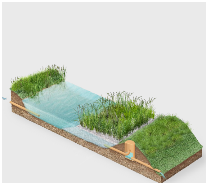
Mozaična rastlinska čistilna naprava dobro prenaša nihanja v dotoku.
