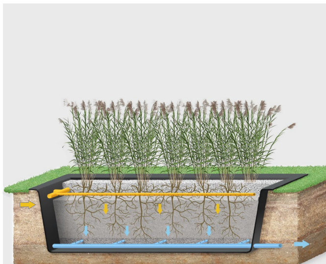
Prerez rastlinske čistilne naprave z vertikalnim tokom vode, kjer se voda preceja skozi substrat.
